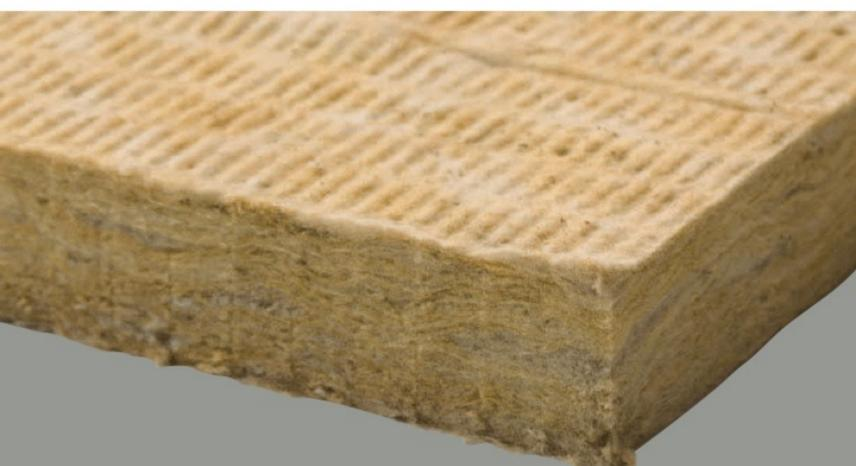
La laine de roche est un matériau isolant qui se place à l'intérieur du mur, devant la plaque de plâtre (exemple d'utilisation sur l'autre page). La laine de roche peut avoir une épaisseur allant jusqu'à 20 cm. Bien que la laine de roche soit connue pour son isolation thermique efficace, elle peut également être utilisée pour l'insonorisation et l'humidité.
